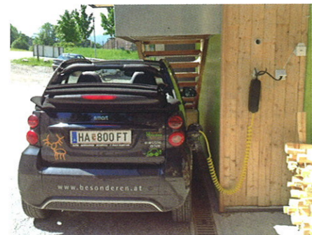
Der kleine E-Smart beim „auftanken“ – mithilfe von Strom aus der eigenen PV-Anlage halten sich die Kosten dafür in Grenzen.
